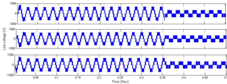
(d) Line voltage of lower inverter
